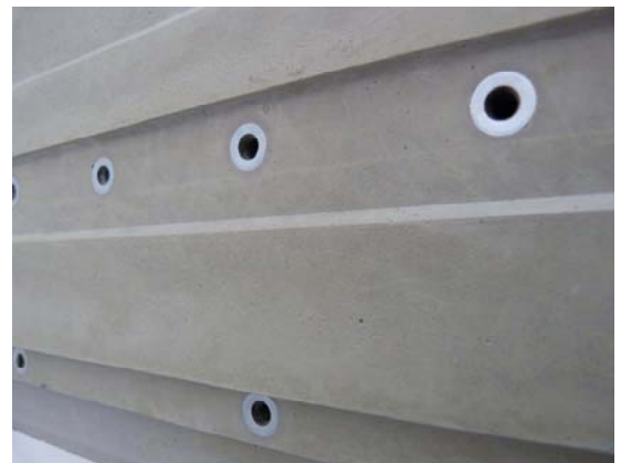
Auf der EMO 2011 zu sehen: Maschinenbetten und -bauteile aus dem High-Tech-Beton Dyckerhoff Nanodur®. Bild: durcrete
